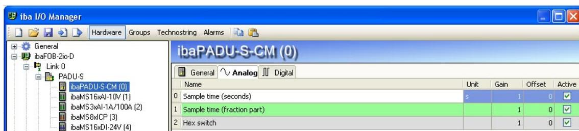
Рис. 17: Модуль PADU-S-CM – сигналы отладки во вкладке "Аналоговые"
