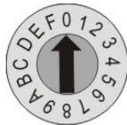
С помощью поворотного переключателя S1 можно устанавливать адреса устройств в оптоволоконной сети.
